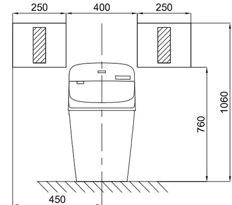
Vị trí lắp đặt: Lắp đặt giá đỡ bộ điều khiển tại mặt tường phía sau, bên trái hoặc bên phải đều được.
