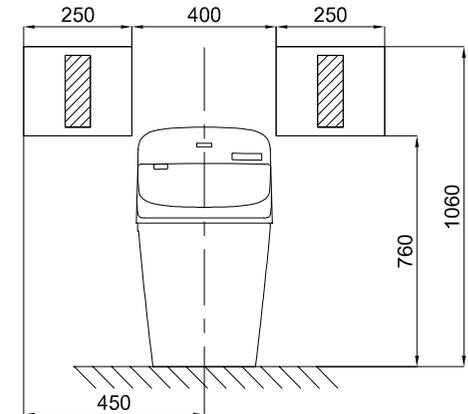
Vị trí lắp đặt: Lắp đặt giá đỡ bộ điều khiển tại mặt tường phía sau, bên trái hoặc bên phải đều được.
