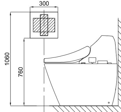
Vị trí lắp đặt: Lắp đặt giá đỡ bộ điều khiển tại mặt tường bên trái hoặc bên phải đều được.
